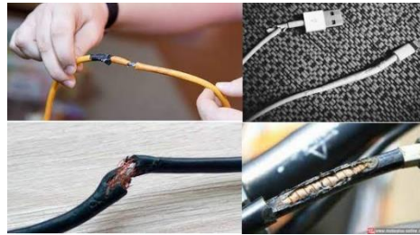
Gambar 12. Kabel rusak dan terkelupas
